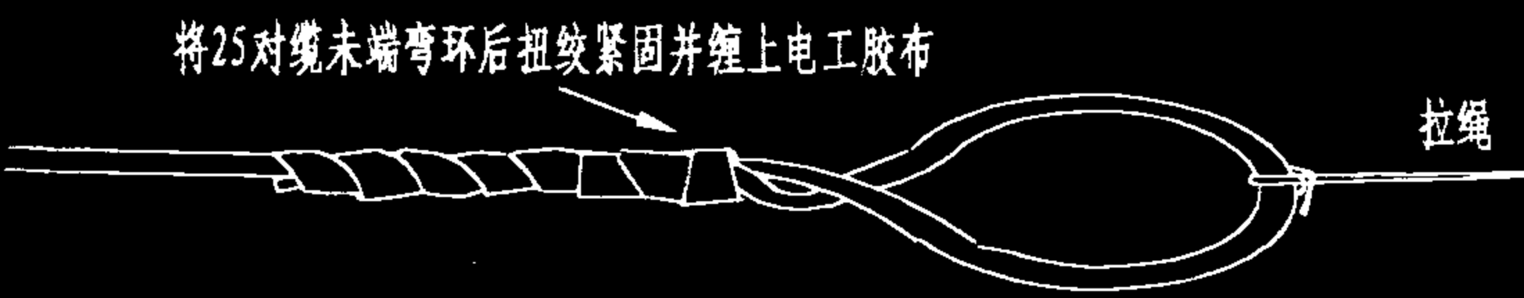
图4 牵引1根25对对绞线的牵引绳连接固定
