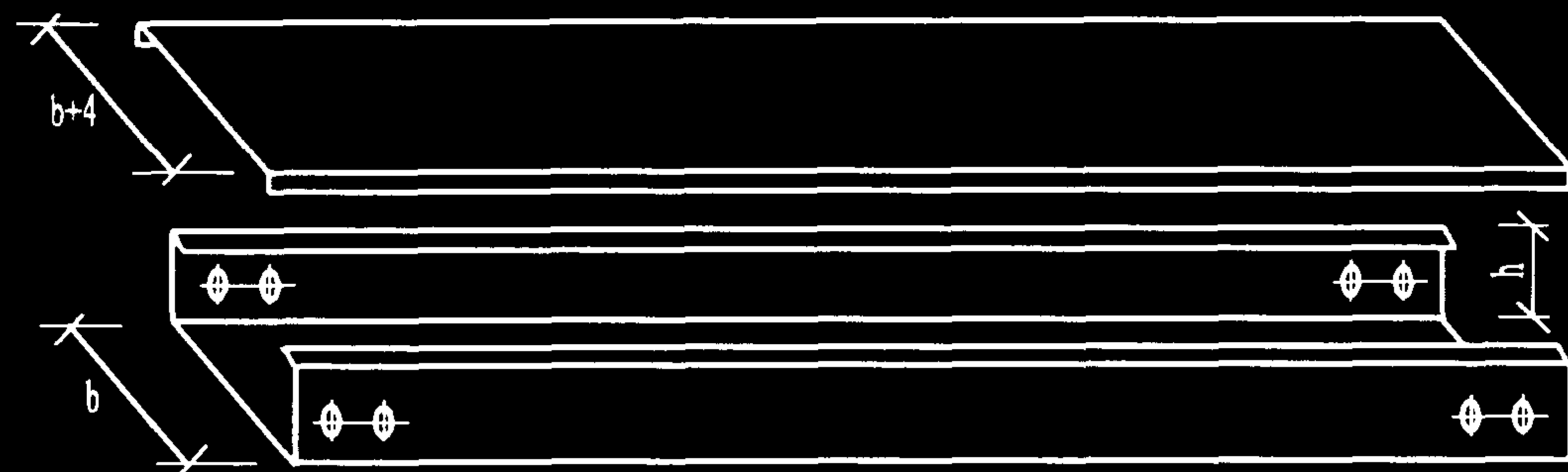
GC-A轻型金属线槽
