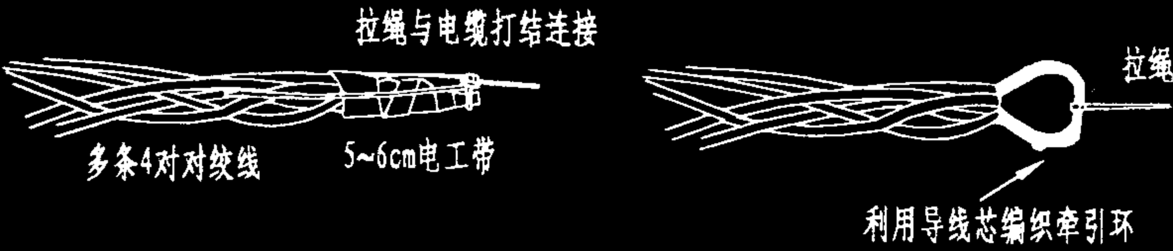
图3 牵引多条4对对绞线的牵引绳连接固定
