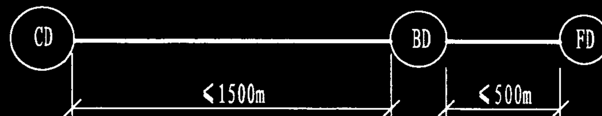
图8 建筑群和建筑物干线布线要求
