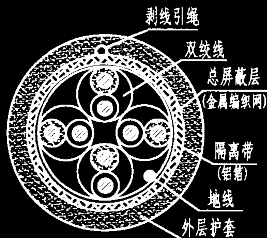
5类4对双总屏蔽对绞电缆 (S-FTP)
