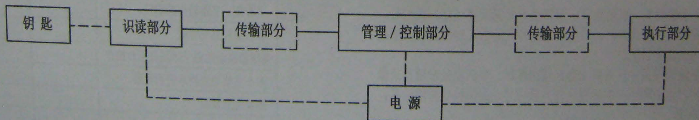
出入口控制系统原理框图
