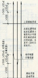
剪力墙竖向分布筋连接构造
