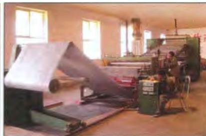
一次性复合成型的防水卷材自动化生产线
