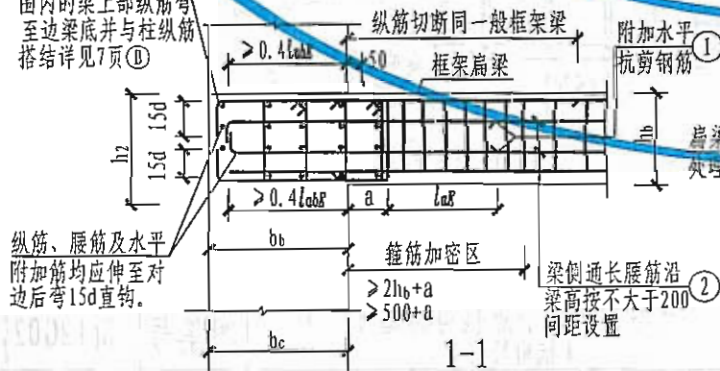
A 边柱(或角柱)平面示意图 (用于角节点时3-3剖面改为1-1剖面)
