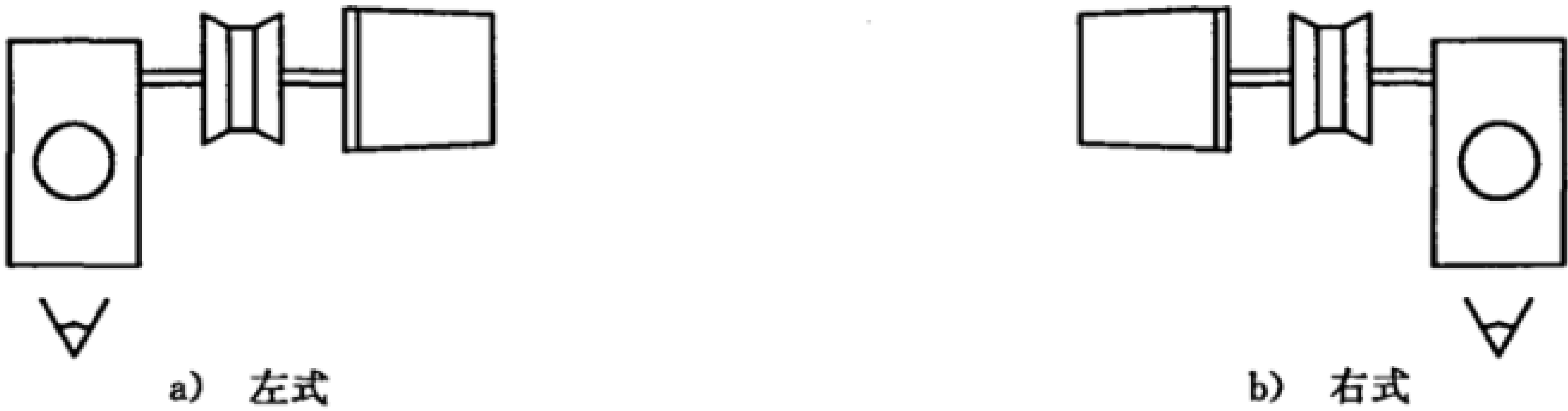
图 2 满载驱动的单锚链轮起锚机(型式 2)
