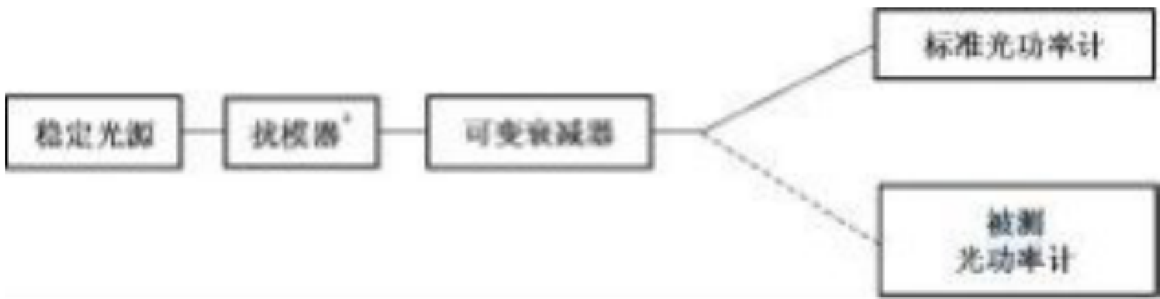
图 2 校准误差测量框图
